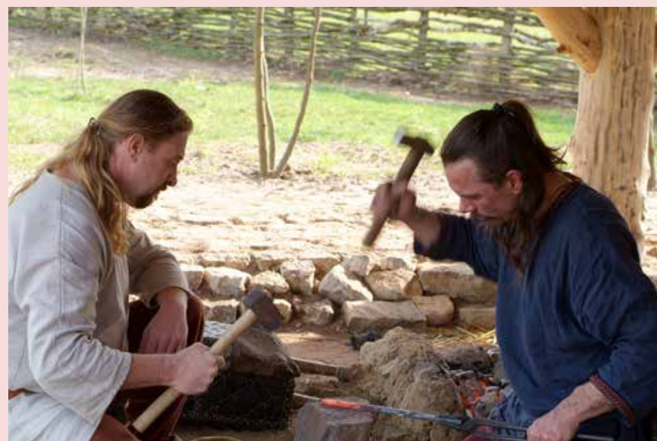
Bei „Feuer und Eisen“ im Juni 2008 wurde das Eisen nach dem Abstich der Rennöfen zu einem Werkzeug geschmiedet.
